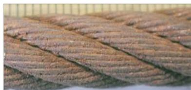
Corrosão moderada. Severidade 40% - Deve ser substituído.
